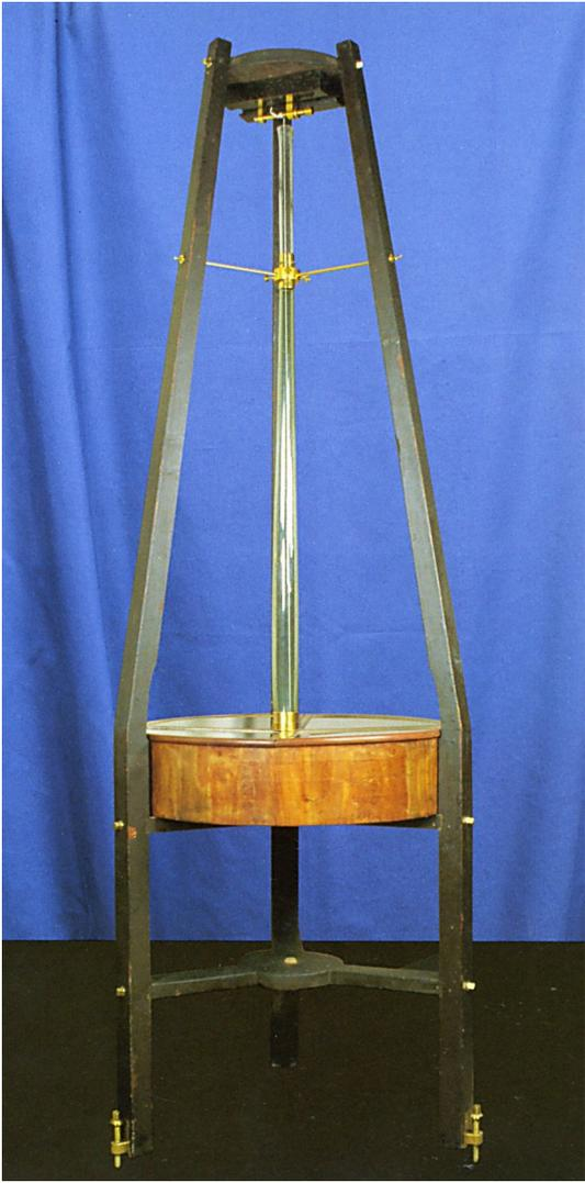
Figura 15: Declinometro magnetico di Meyerstein (1835).
