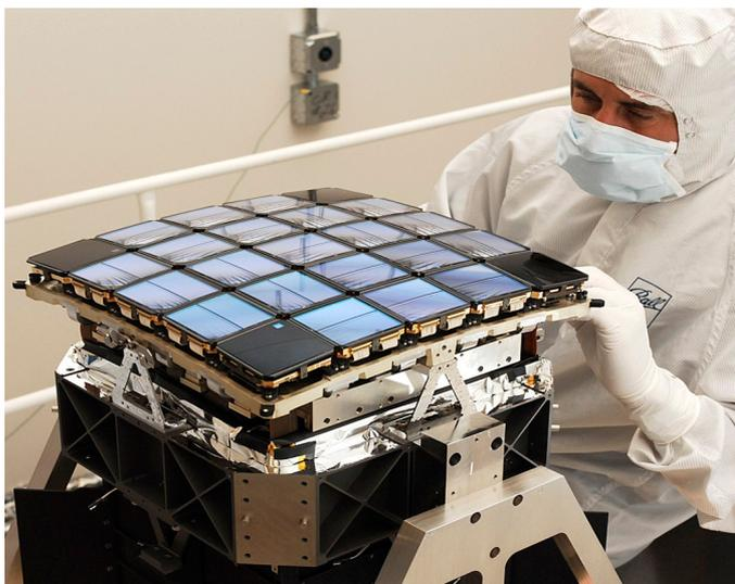
Figura 39: Il satellite *Kepler*, dedicato alla ricerca di pianeti extrasolari, è equipaggiato con una camera Schmidt da 140 cm di diametro; al fuoco primario del telescopio è posto un sensore (nella foto) formato da un mosaico di 42 rilevatori digitali (CCD) disposti su una superficie curva.
