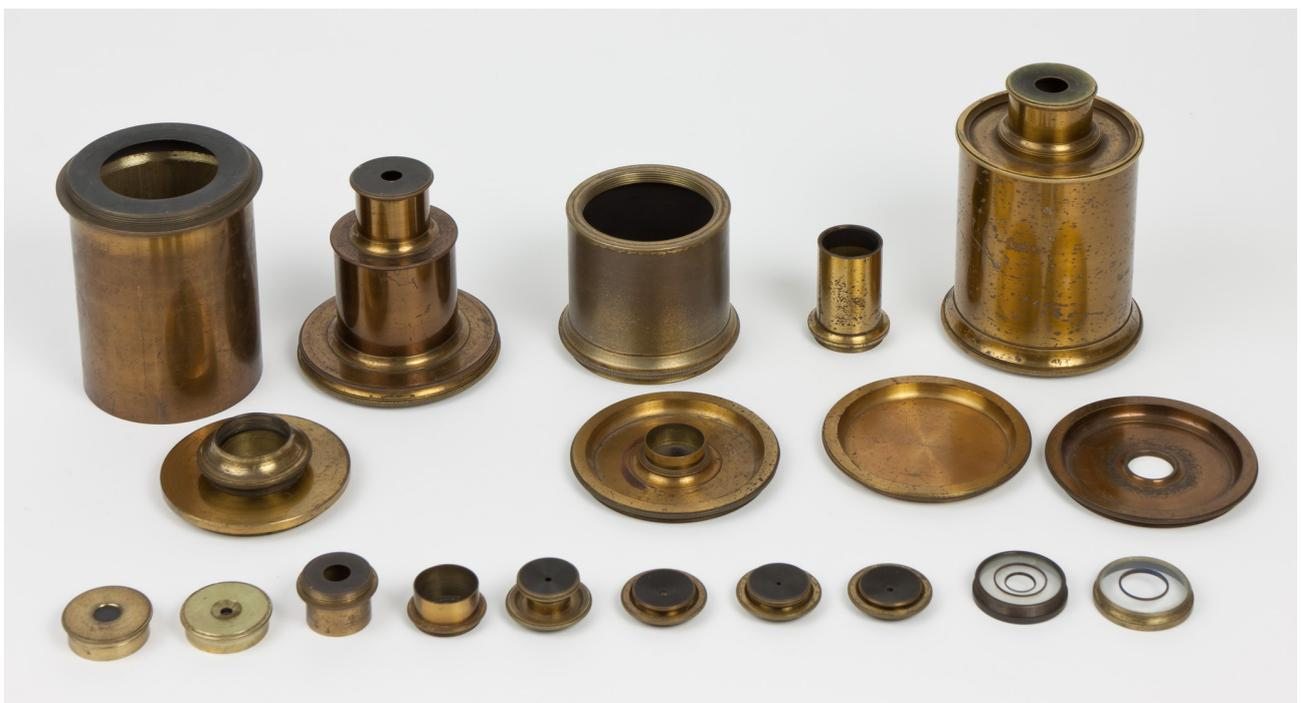
Figura 29: Il corredo di oculari del telescopio Merz-Repsold da 49 cm dell'Osservatorio Astronomico di Brera (il telescopio è attualmente esposto nel Museo della Scienza e della Tecnologia *Leonardo da Vinci* di Milano).
