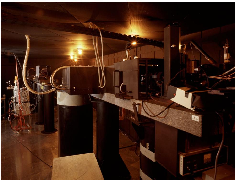
Figura 37: Il fuoco *coudé* è completamente indipendente dai movimenti del telescopio e spesso ha la struttura di un vero e proprio laboratorio di ottica, in cui possono essere utilizzati strumenti molto complessi (nella foto, il *Coudé Echelle Spectrometer* installato al telescopio da 3.6 m dell'*European Southern Observatory* a La Silla, Cile).
