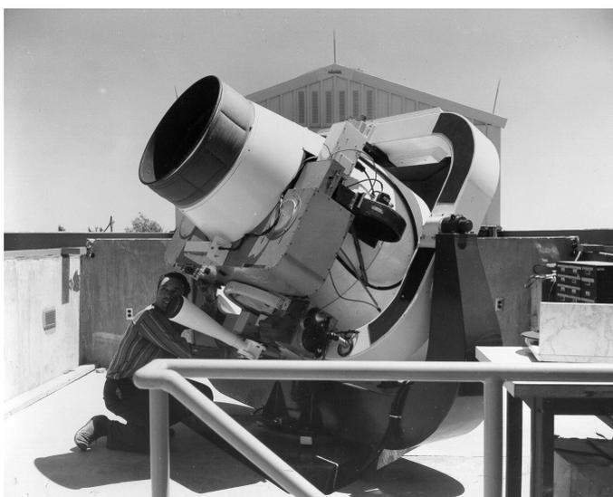
Figura 40: Una delle camere Baker-Nunn usate dallo Smithsonian Astrophysical Observatory per l'osservazione di satelliti artificiali durante l'Anno Geofisico Internazionale (1957-58); ha un rapporto focale di  $f/1$  e un campo di vista di 30 gradi.
