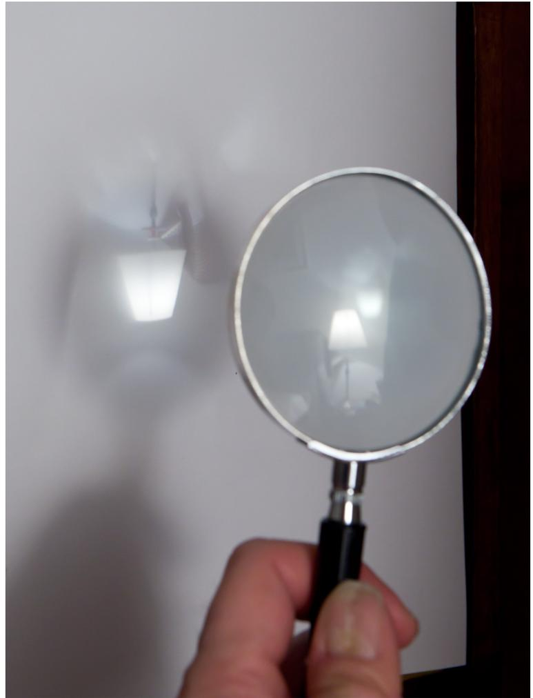
Figura 8: Formazione di un'immagine (rovesciata) da parte di una lente convergente, per proiezione su uno schermo bianco. Si noti che anche la superficie della lente riflette un'immagine della stessa scena.
