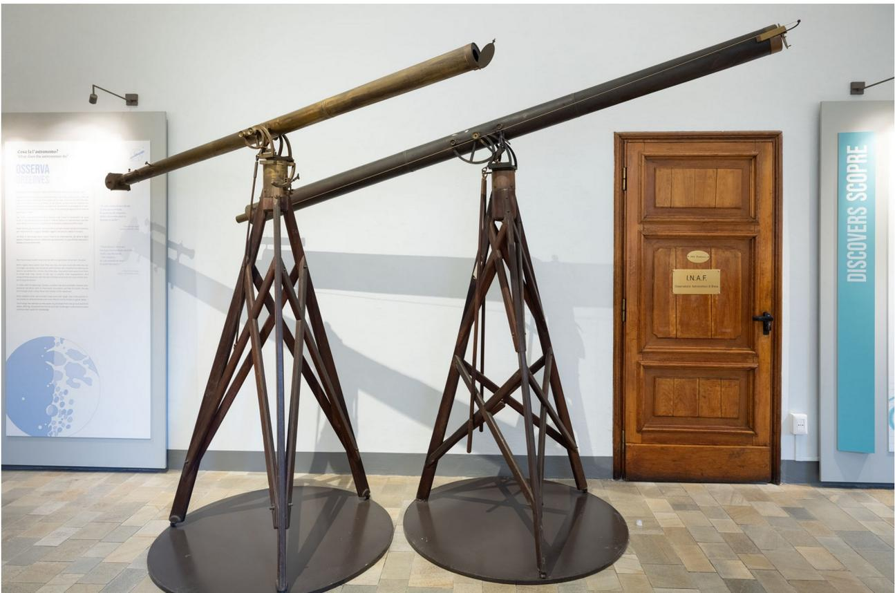
**Figura 36:** I due telescopi rifrattori costruiti da Giuseppe Megele, attualmente esposti nella galleria del Museo Astronomico di Brera. *A sinistra:* telescopio con obiettivo da 7,6 cm di diametro e 240 cm di focale, del 1778; *a destra:* telescopio con obiettivo da 9 cm di diametro e 305 cm di focale, del 1785. Entrambi gli strumenti montavano obiettivi acromatici prodotti da Peter Dollond.
