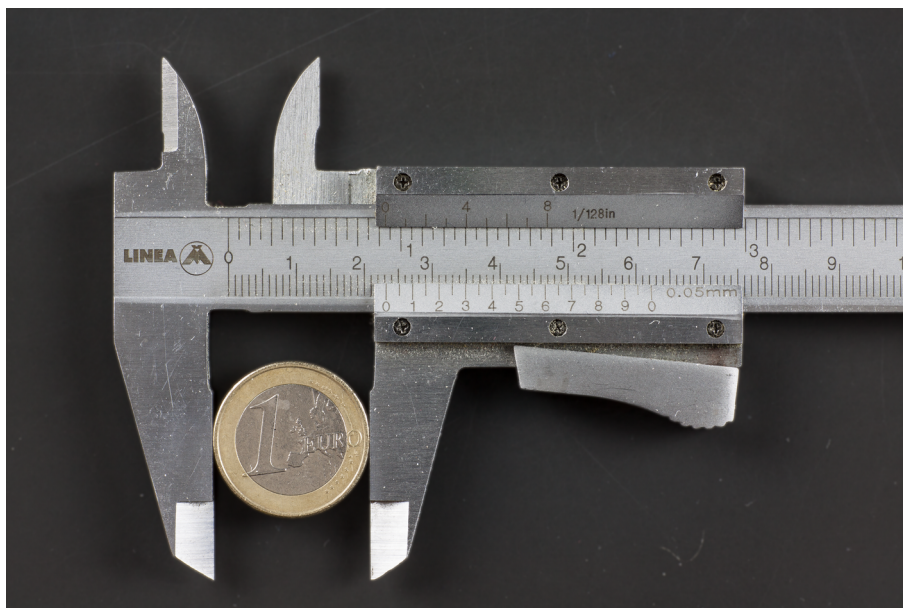
Figura 6: Un calibro dotato di nonio ventesimale; la lettura fornita dallo strumento è 23.20 \pm 0.05 mm.
