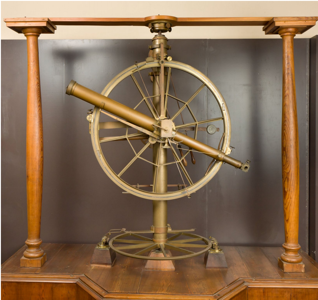
Figura 8: Strumento di precisione per la misura delle coordinate celesti, costruito nel 1808 da Georg Friedrich von Reichenbach, uno dei più famosi costruttori di strumenti astronomici del XIX secolo. È dotato di una mira telescopica di 110 cm di focale e di due grandi cerchi graduati (del diametro di 75 e 100 cm) che permettono di leggere contemporaneamente l'altezza dell'astro sull'orizzonte e il suo azimut (distanza angolare rispetto alla direzione sud). Il cerchio verticale è diviso in ventesimi di grado centesimale ( 2'.7 ) ed è dotato di quattro nonii centesimali che forniscono intervalli di 1''.62 e che potevano essere letti per mezzo di due microscopi montati su un braccio rotante. Lo strumento è attualmente esposto nella galleria del Museo Astronomico di Brera.
