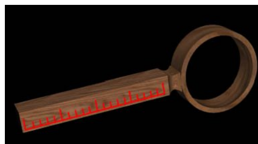
Figura 10: Ricostruzione ipotetica del regolo graduato usato da Galileo Galilei per le sue osservazioni dei satelliti di Giove.
