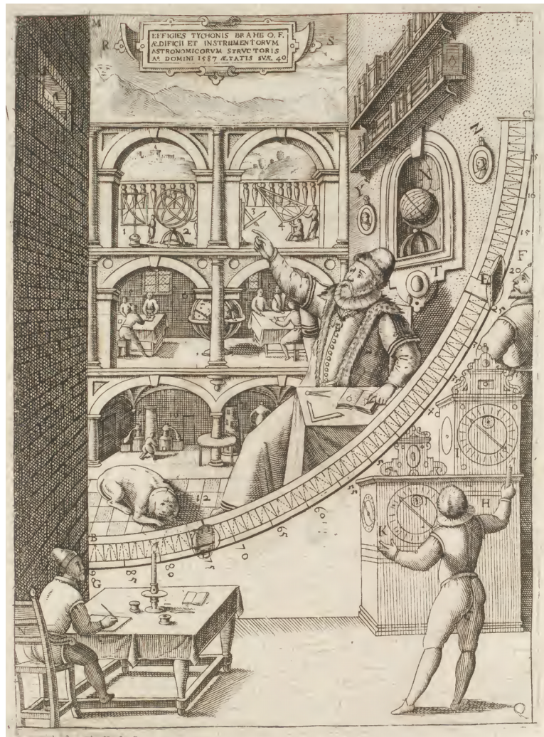
Figura 1: Il grande quadrante murale costruito da Tycho Brahe nel 1582; la scala graduata, dotata di due mire indipendenti, è fissata su una parete orientata in direzione nord-sud, decorata da un grande affresco che ritrae l'astronomo all'interno del suo castello-osservatorio. Si notino in particolare: la finestrella, in alto a sinistra, che contiene la mira fissa attraverso cui venivano traguardati gli astri; la suddivisione fine della scala graduata per mezzo di linee trasversali (vedi figura 4); la presenza di due orologi, in basso a destra, che dovevano servire per la determinazione dell'ascensione retta degli astri attraverso la misura dei tempi di passaggio al meridiano.
