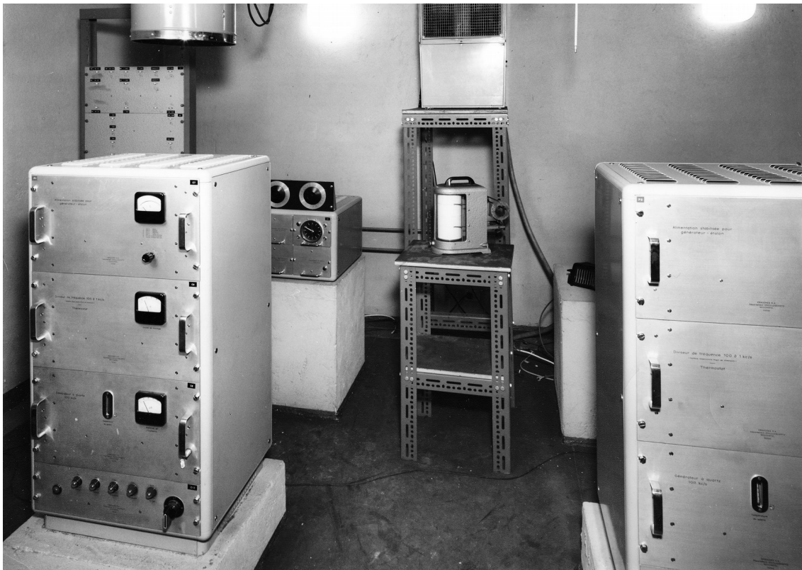
Figura 17: I due orologi al quarzo Ebauches installati all'Osservatorio di Brera per il servizio del tempo dopo il 1957.
