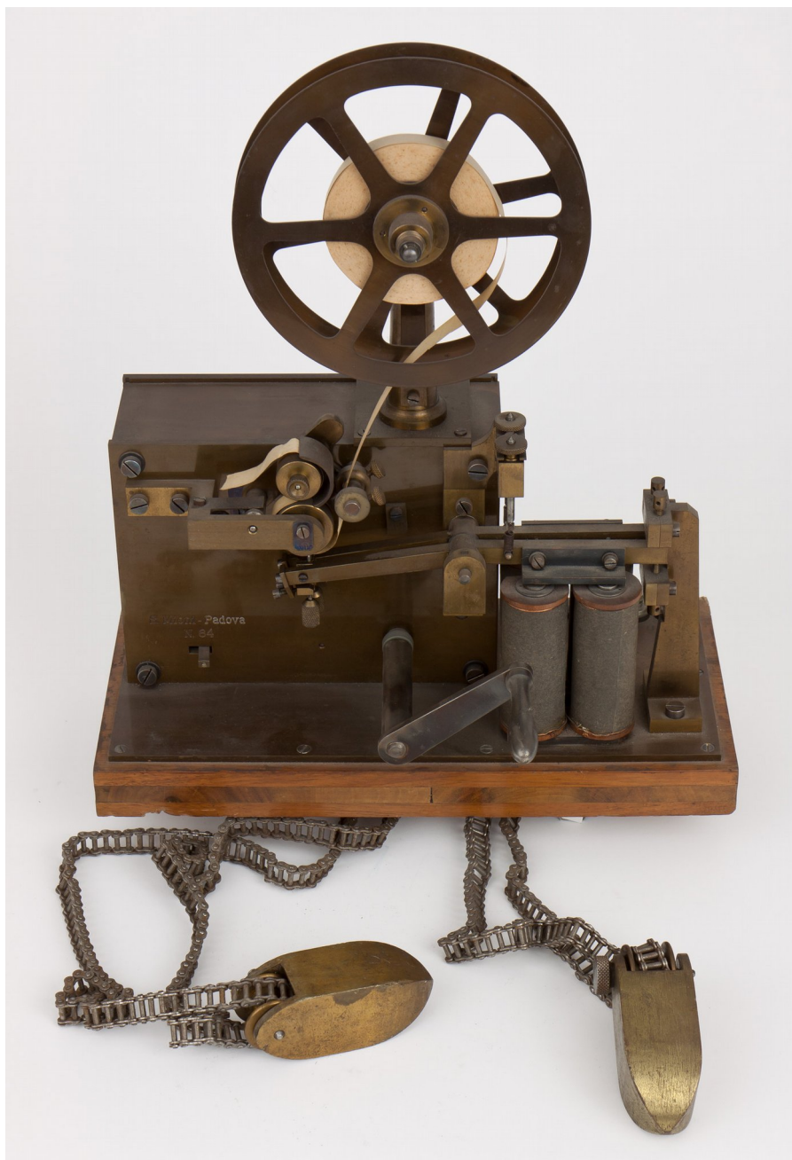
Figura 4: Uno dei cronografi registratori che sono stati in uso all’Osservatorio di Brera; lo strumento è stato costruito da Sante Mioni, meccanico dell’Osservatorio Astronomico di Padova, negli anni ‘20 del Novecento. Dalla parte inferiore sporgono i due pesi che, con la loro discesa, fornivano la forza motrice al meccanismo di trascinamento della carta.
