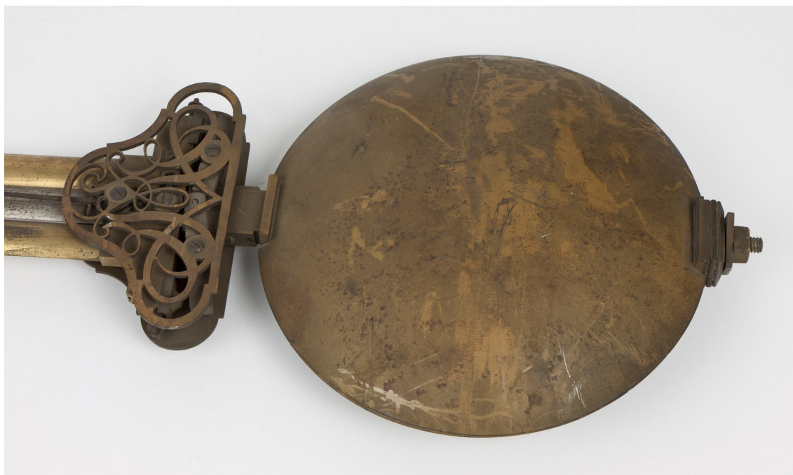
Figura 8: La parte terminale dell'asta, la lente e il meccanismo di compensazione termica del primo pendolo di Megele.
