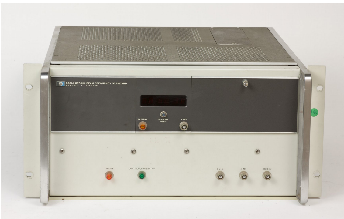
Figura 18: Il campione di frequenza al cesio Hewlett Packard 5061A in dotazione al servizio dell'ora dell'Osservatorio di Brera negli anni '60 del Novecento.
