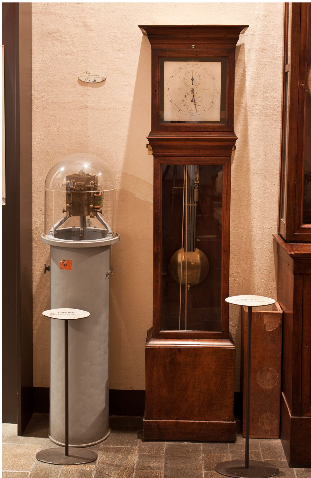
Figura 13: Il secondo degli orologi a pendolo di Carlo Grindel (a destra) e il pendolo Riefler per misurazioni gravimetriche (a sinistra). Del contenitore metallico in dotazione al pendolo Riefler rimane solo la parte inferiore; la parte superiore, che consisteva in un altro cilindro metallico dotato di oblò, è mancante e sostituita da una campana di plexiglas ai fini dell'esposizione museale.
