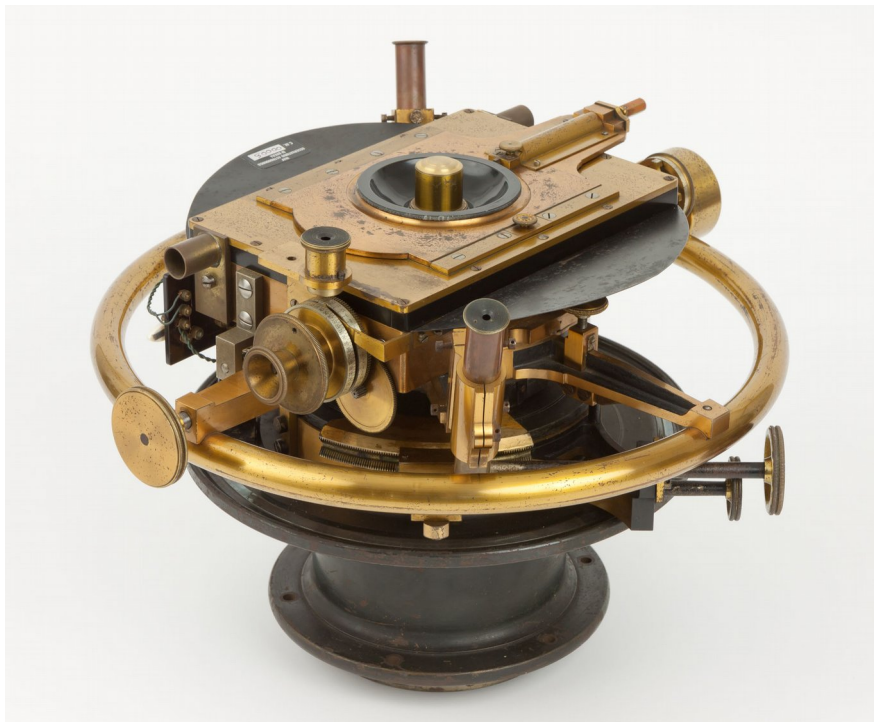
Figura 19: Il micrometro filare Merz in dotazione al rifrattore Merz-Repsold da 18 pollici.
