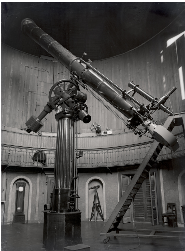
Figura 18: Il rifrattore Merz-Repsold nella sua cupola a Brera; la presenza dello spettrografo Zeiss (Z1) al fuoco dello strumento permette di datare la fotografia al 1926 o poco dopo (ma certamente prima del 1936, anno in cui il telescopio fu trasferito a Merate).
