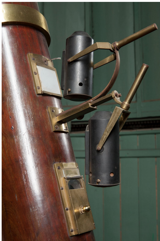
Figura 7: Le due lampade poste sopra il tubo del telescopio Merz 8”, con le due finestrelle che consentono alla luce di entrare nel tubo e illuminare i fili del micrometro; la finestrella inferiore è dotata di uno sportellino scorrevole che permette di regolare l’intensità della luce. Le due lampade sono ricostruzioni eseguite nel corso del restauro del 1999: le lampade originali sono andate perdute quando il sistema di illuminazione era stato elettrificato.
