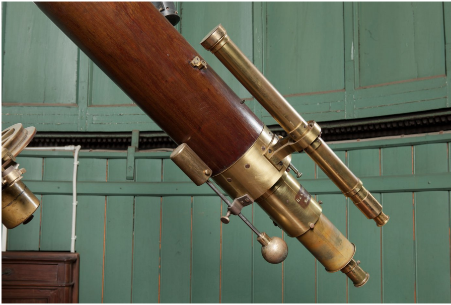
Figura 8: Particolare della sezione inferiore del tubo del rifrattore Merz 8" con la torretta portaoculare, il cercatore e il contrappeso scorrevole che permette di regolare il bilanciamento del telescopio a seconda del peso dell'oculare inserito.
